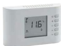
**Funciones principales:** encendido y apagado de la unidad - ajuste de la temperatura ambiente - selección calefacción/frío manual o automática - selección manual o automática de 3 velocidades - pantalla para lectura/visualización de temperatura ambiente y set point - control de válvulas moduladoras (0-10 Vdc) y motor ECM o asíncrono - válvulas on/off y motor ECM - programabilidad de funciones - **CONFIGURACIÓN DE LA VÁLVULA ON/OFF Y MOTOR ASÍNCRONO NO COMPATIBLE**
