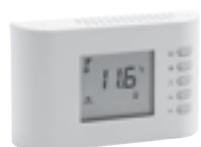
**Funzioni principali:** accensione e spegnimento dell'unità - regolazione temperatura ambiente - selezione riscaldamento/raffrescamento manuale o automatica - selezione 3 velocità manuale o automatica - display per lettura/visualizzazione temperatura ambiente e set point - comando valvole on/off e flottanti (3 punti) - comando resistenza elettrica - programmabilità delle funzioni
