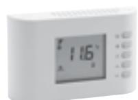
**Funzioni principali:** accensione e spegnimento dell'unità - regolazione temperatura ambiente - selezione riscaldamento/raffrescamento manuale o automatica - selezione 3 velocità manuale o automatica - display per lettura/visualizzazione temperatura ambiente e set point - comando valvole modulanti (0-10 Vdc) e motore ECM o asincrono - valvole on/off e motore ECM - programmabilità delle funzioni - **CONFIGURAZIONE VALVOLE ON/OFF E MOTORE ASINCRONO NON COMPATIBILE**
